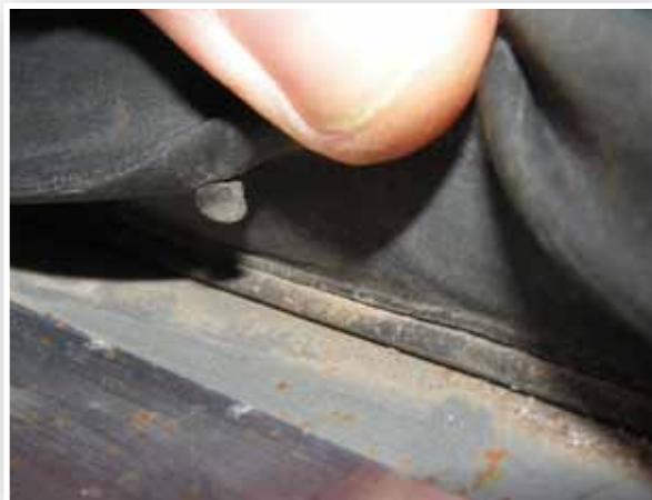
Idealnie czysta wewnętrzna część uszczelki i osłonięty nią fragment progów rodzi podejrzenia poważnej naprawy blacharskiej.
