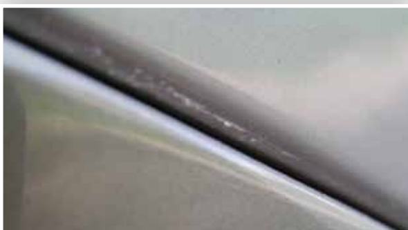
Ślady pasty polerskiej na uszczelkach i łączeniach to oznaka interwencji lakiernika.
