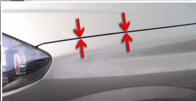
Źle spasowane elementy poszycia zdradzają interwencję blacharza.
