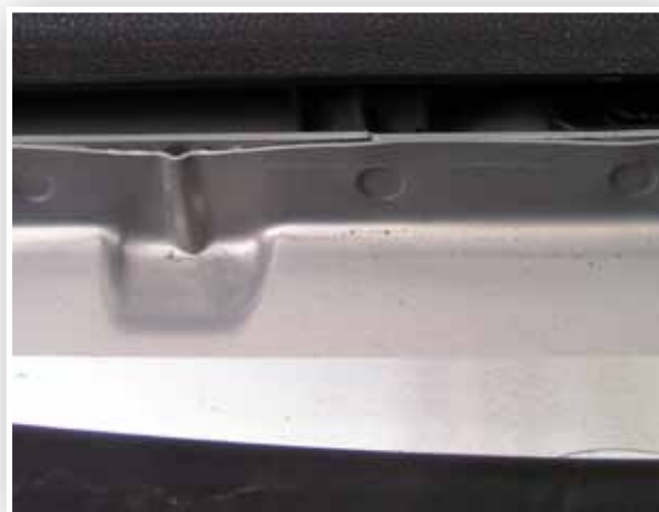
Wklęsłe fragmenty na łączeniach elementów blacharskich cechują fabryczne zgrzewy.
