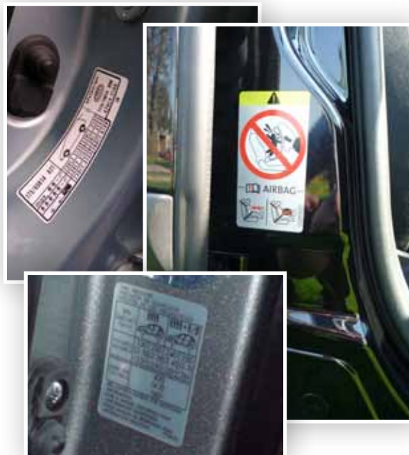
Brak naklejek, to przesłanka do solidnej kontroli wszystkich progów i słupków.
