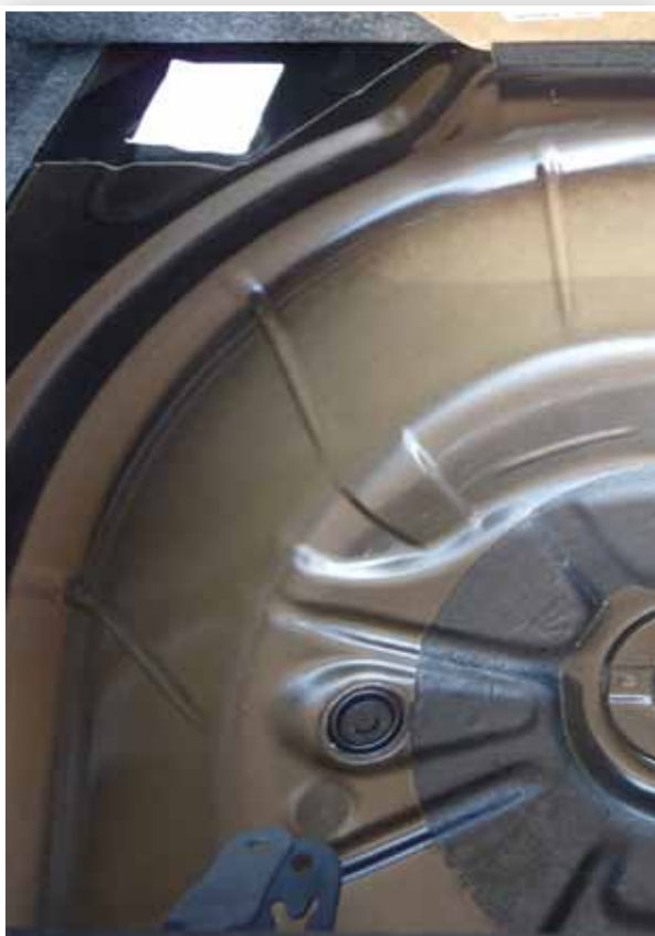
Płyta podłogowa bagażnika może ujawnić ślady po „przeszczepie ćwiartki”.
