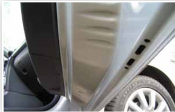
Spód drzwi jest szczególnie narażony na korozję.
